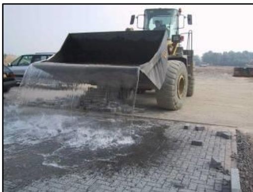
In 2001 alleen afvoer met waterpasserende stenen Nu kiest men vaak voor WT kolken
