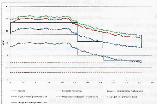
Figuur 2: Doorsnede ontwerp Van Ambestraat – Van Bronkhorststraat; donkerblauwe rechthoeken geven de waterbergende compartimenten weer.
