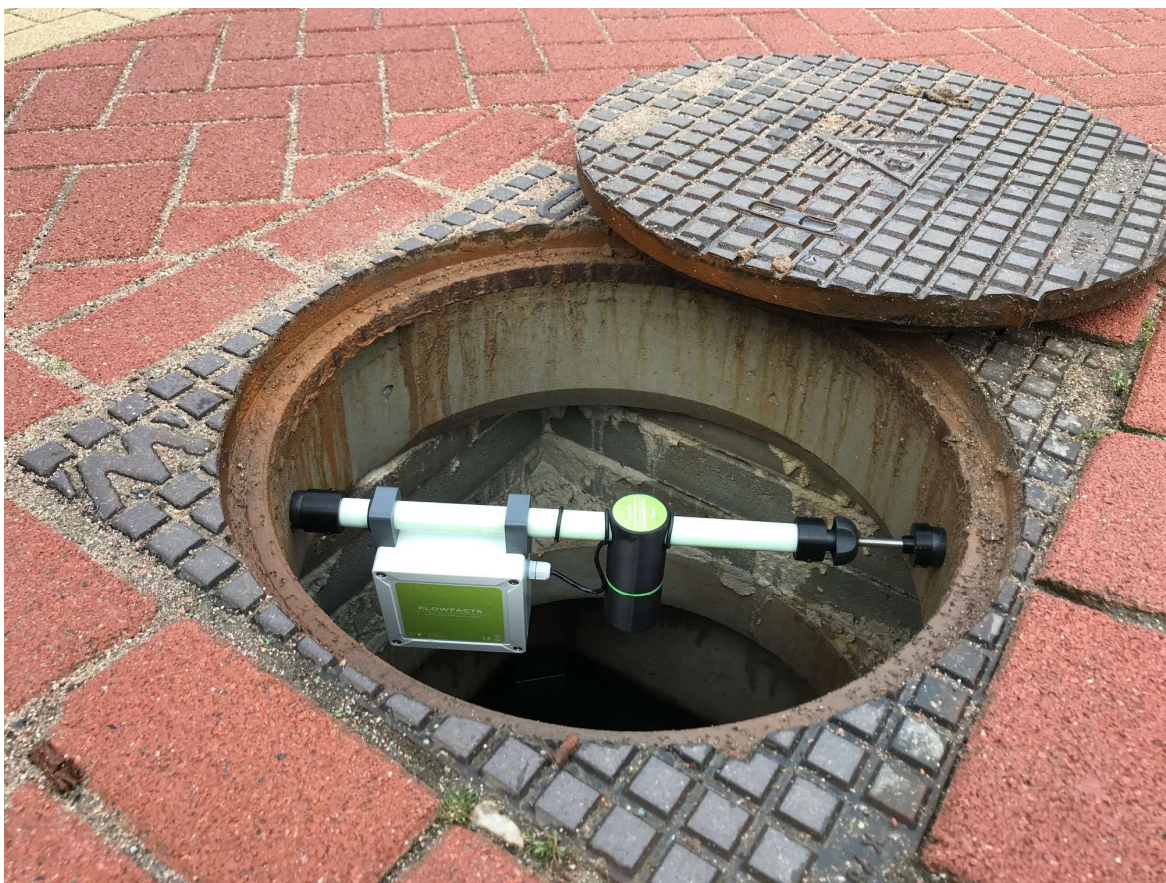
Flowfacts montagestang met daaraan een meet- en communicatiemodule
