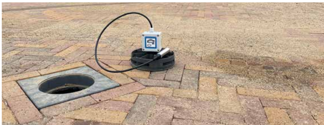
Monitoren met Flowfacts aan een circulaire Aquaflo wegfundering
