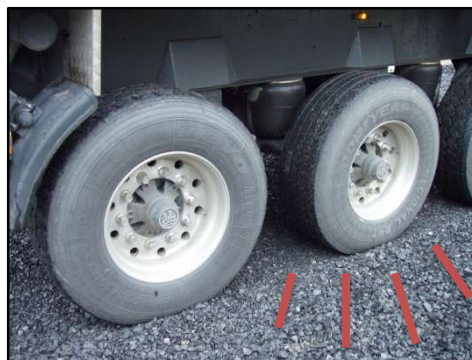
Figuur 2: hoek van inwendige wrijving > 55° levert brede spreiding van krachten naar de ondergrond.
